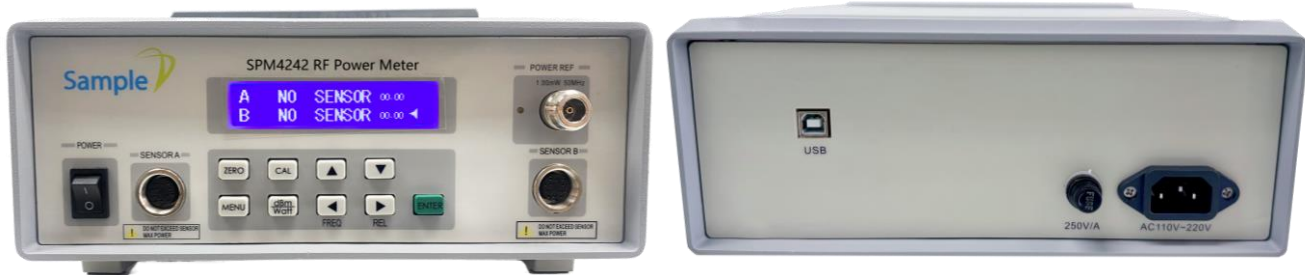
SPM4240系列射频微波功率表前后面板
