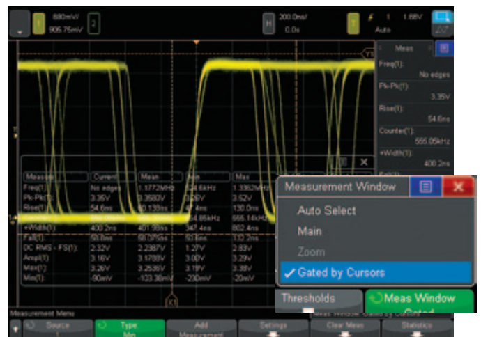
图32: 同时显示多达10种自动测量。测量可以通过光标进行选择。
