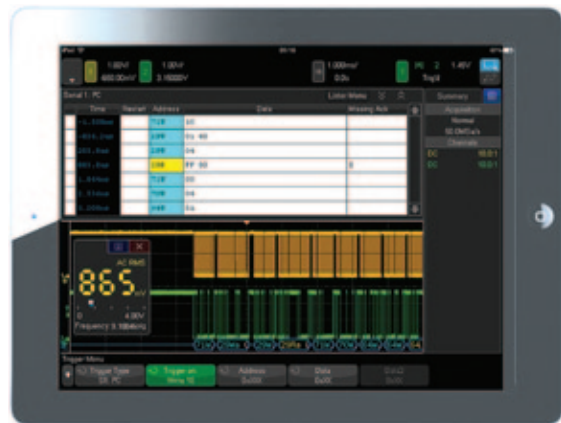
图 37: 平板电脑虚拟前面板控制界面。
