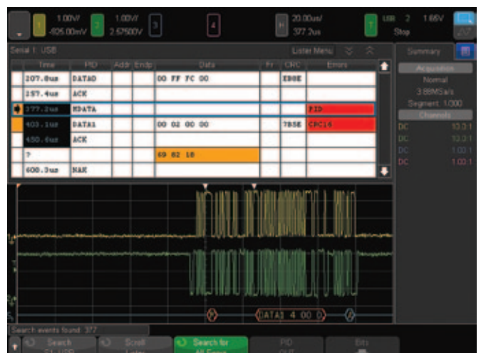
图 20: USB 2.0 触发、解码和“列表”显示。
