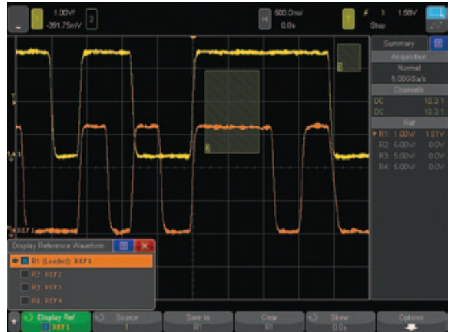
图 33: 存储和调用多达 4 个参考波形。
