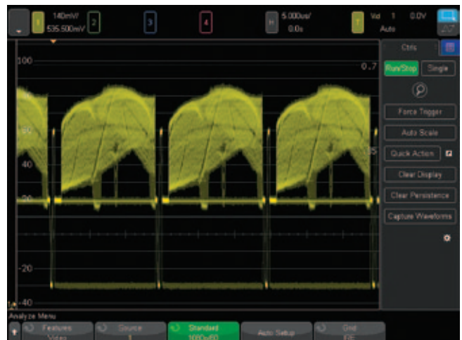
图 26: 在 1080p HDTV 信号分析上进行触发。
