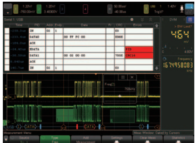
图 30. USB 2.0 协议触发与解码选件的结果显示。
