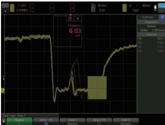
图 12. 基于硬件实现的 InfiniiScan Zone 触发，简单易用。
