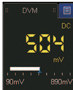
图 31. 电压表显示，完全和示波器通道独立
