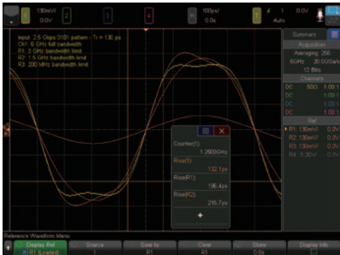
图 1. 被测对象为上升沿是 130 ps (10-90%) 的信号。不同带宽示波器的测量结果:
