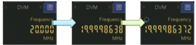
图 33. 精密 10 位计数器测得时钟的真正频率略低于 20 MHz
