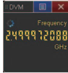
图 32. 10 位计数器精确测量 2.5 GHz 信号的频率
