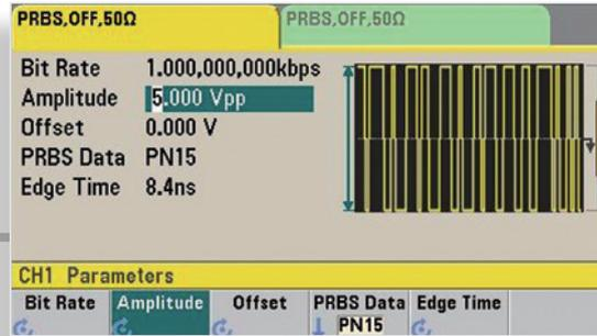
Waveform Builder Pro 在 33600A 系列波形发生器中轻松生成 PRBS 波形。
