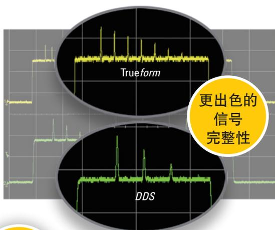
在过去二十年中，直接数字合成 (DDS) 一直是函数发生器和经济型任意波形发生器的理想波形生成技术。DDS 技术以较低的成本，实现较高的频率分辨率，并可生成的定制波形。
