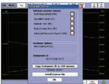
透過驗證客戶使用碼，由WK 回傳.dat 檔到客戶的USB 裝置上，可輕易完成儀器升級動作
