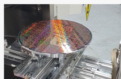
适应八英寸晶圆的载物台和样品仓
